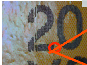
スタンドを傾けて表面の凹凸を観察(25倍)
