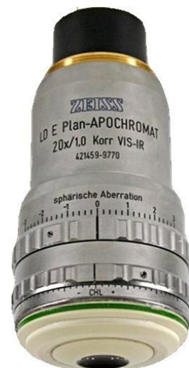
超長作動距離 (5.6 mm) 対物レンズ Super-long working distance (5.6 mm) objective
