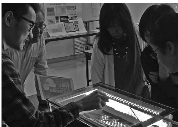
写真1 霧箱による飛跡観察の様子。
