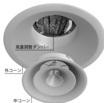
図 4. 給気口（アネモ丸形吹出口）の構成 中コーンにフィルタを取り付けた。奥には老朽化により粉塵の発生原因の 1 つとなっているダンパーをはめ込み合成した。
