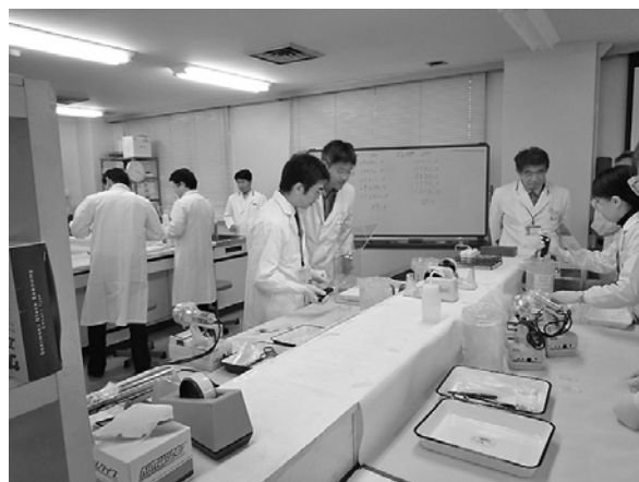
写真3 非密封放射性同位元素溶液を用いて標準試料を作成している様子（実習Ⅰ）。
