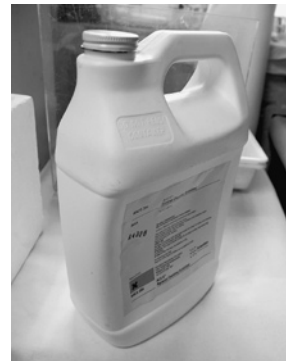
図14 内圧減少により変形した樹脂容器
