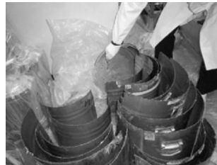
図10 液体シンチレーター廃液容器の汚染検査 除染後は、スミア法により全て汚染検査を行った。
