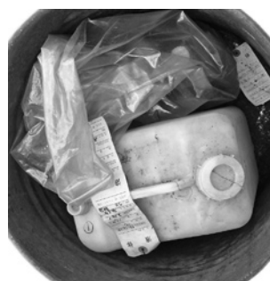
図2 保管廃棄容器(ドラム缶)内の様子 容器内側かなりの錆が発生していた。
