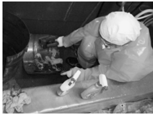
図9 液体シンチレーター廃液容器の除染
