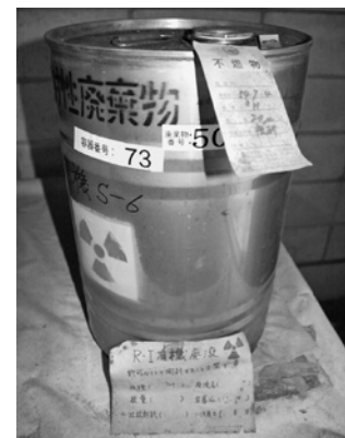
図8 液体シンチレーター廃液容器
