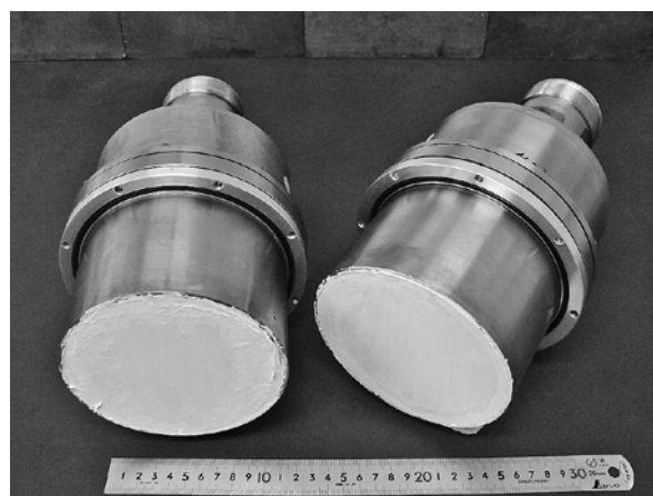
図3. 全吸収BGO検出器。線源を挟み込むように、2台のBGOシンチレーション検出器を配置して測定する。
