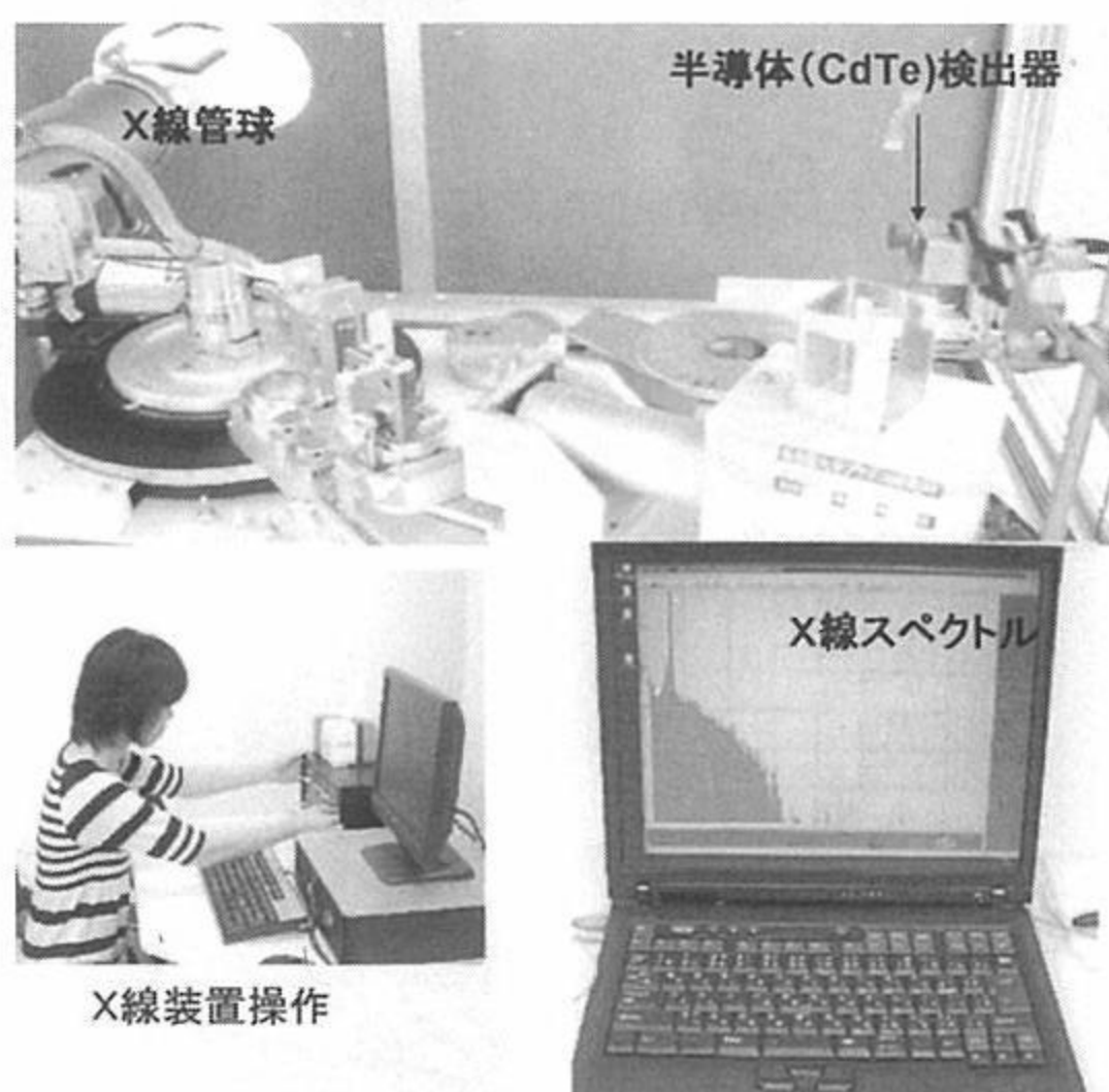
図3 X線スペクトルおよび検出器
