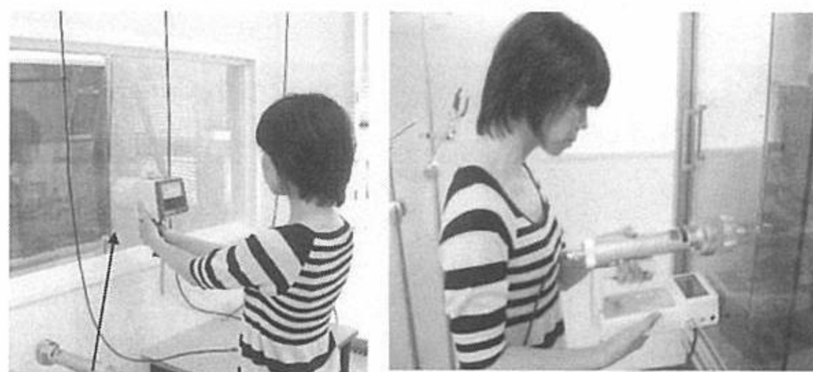
電離箱式サーベイメータ
