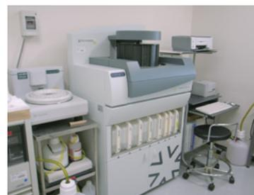
写真4:自動免疫染色装置 標本をセットして2時間で染色が完了する。
