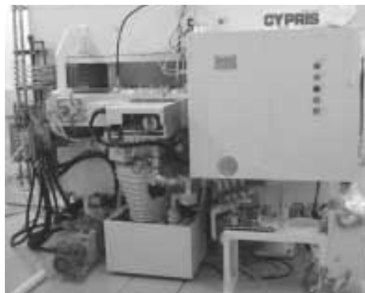
図6. サイクロトロン (CYPRIS HM-18 住友重機製 新規導入)
