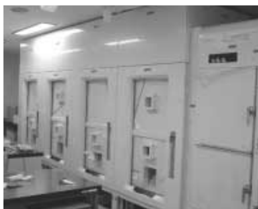
図7. ホットラボ、放射性薬剤自動合成装置 (F-18 FDG合成装置F-200、ガス状標識化合物合成装置、C-11研究用合成装置、F-18研究用合成装置住友重機製 新規導入)
