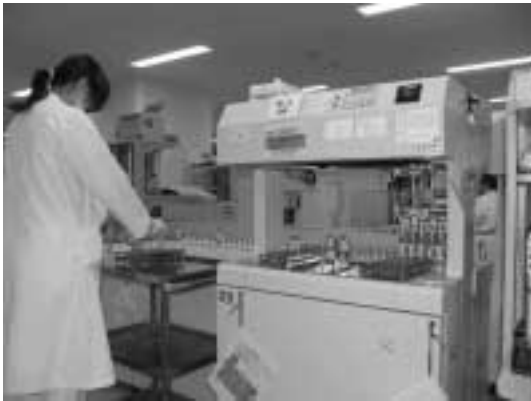
写真2 ベルトコンベアによる検体搬送
