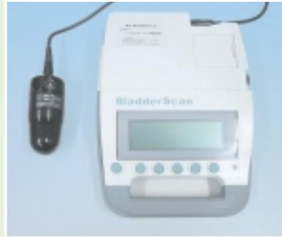
ブラダースキャン：超音波で膀胱内の残尿量を自動的に計測できます。
